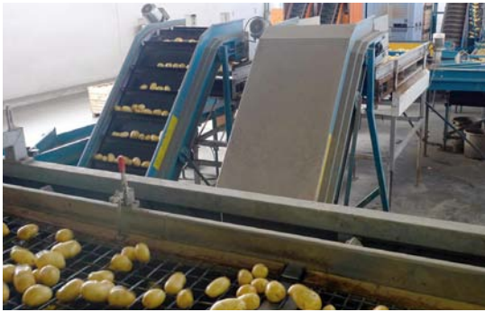
Cintes transportadores que conduïxen les trufes calibrades a la zona de pesada i condicionament a l'empresa ETS Gourgues.
